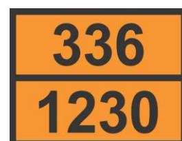
Figure 119 Exemple de plaque orange : en haut, le code danger (33 signifie très inflammable et 6 toxique) et, en bas, le code matière (ou n° ONU)
