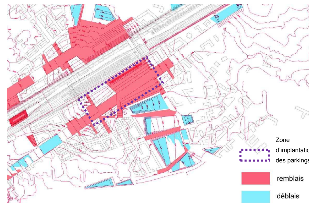
Figure 94 : Schéma de localisation des remblais et déblais réalisés pour le projet Oz (Source SAAM)
