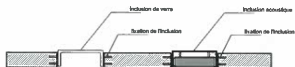
COUPE DE PRINCIPE SUR LES INCLUSION DE VERRE ET INCLUSION ACOUSTIQUE 1/10
