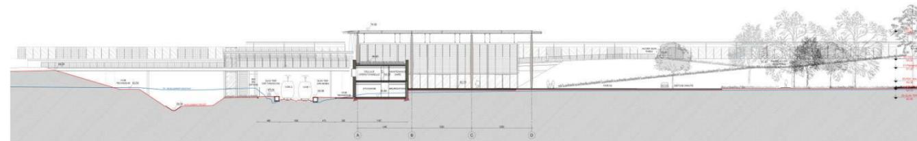
CPE 3 : Coupe transversale sur le bâtiment de service (2 niveaux), le hall voyageurs et les voies TER
