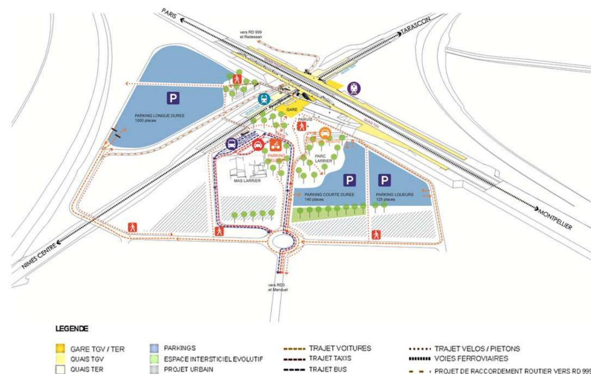
Figure.38 - Schéma organisationnel des différents modes au sein du Pôle d'Échange Multimodal
