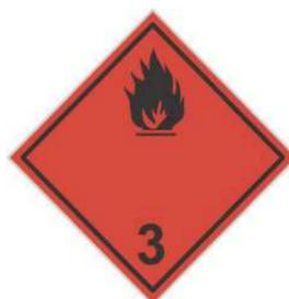
Figure 127 : Exemple d'étiquette annonçant le type de danger (Ici : danger de feu -matière liquide inflammable).
