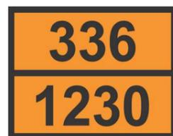
Figure 126 Exemple de plaque orange : en haut, le code danger (33 signifie très inflammable et 6 toxique) et, en bas, le code matière (ou n° ONU)
