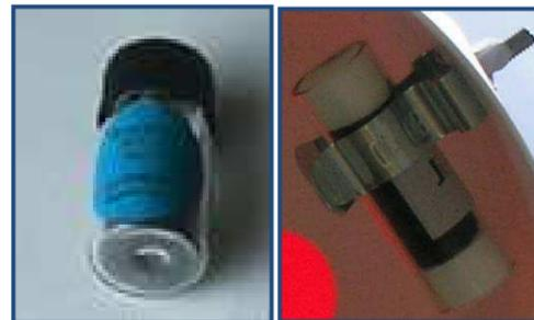
Figure 139: Tubes passifs en BTEX (mesure du Benzène)
