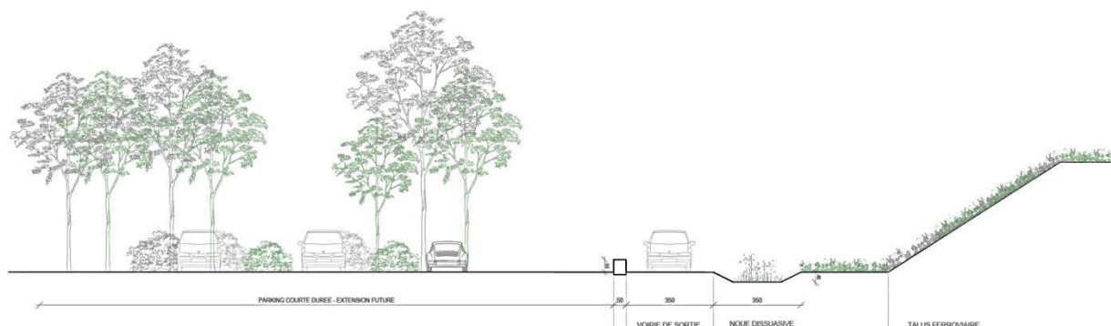
Figure 38 : coupe sur noues en pied de talus
