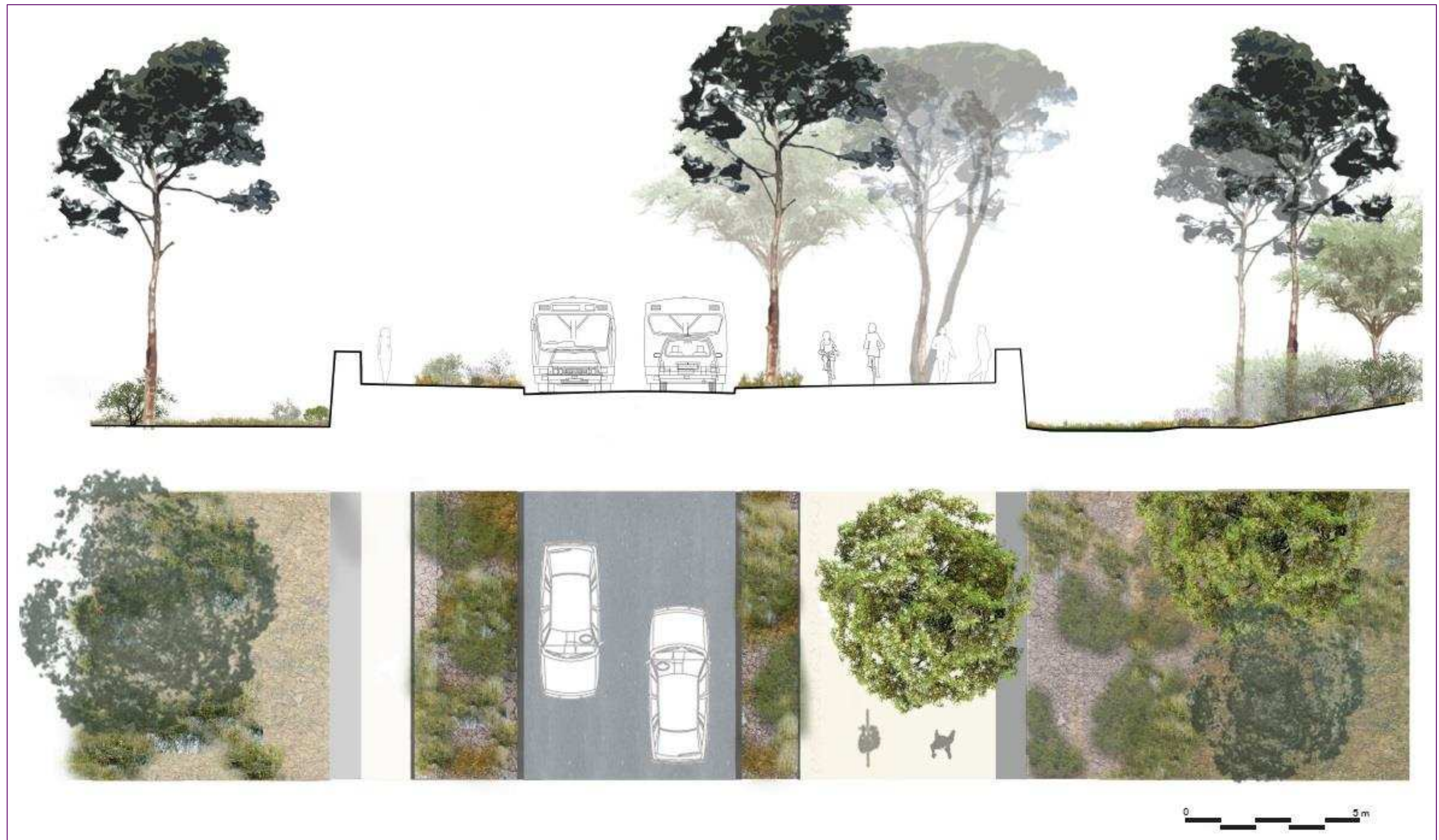
Figure 9 : Coupe de la route digue
