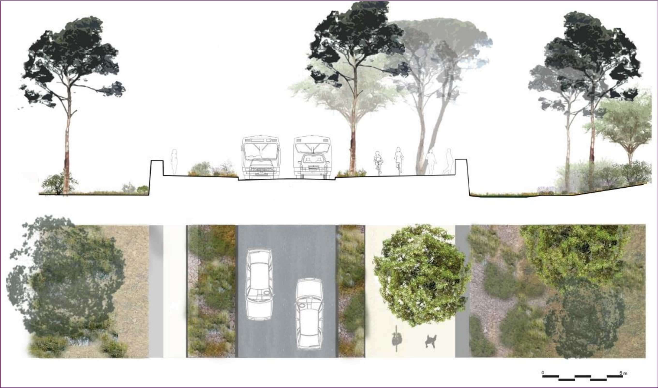
Figure 8 : Coupe de la route digue
