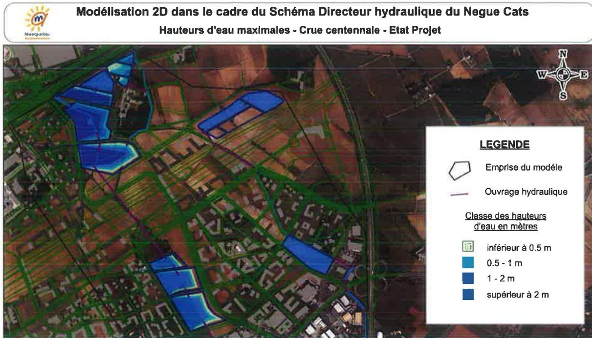
**Figure 9 : Zone inondable centennale du Negue Cats au terme du schéma directeur**
